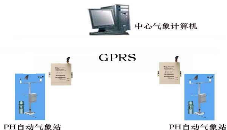
图 3-2 采用 GPRS 无线通讯方式的自动气象站监测网络图（方式二）
