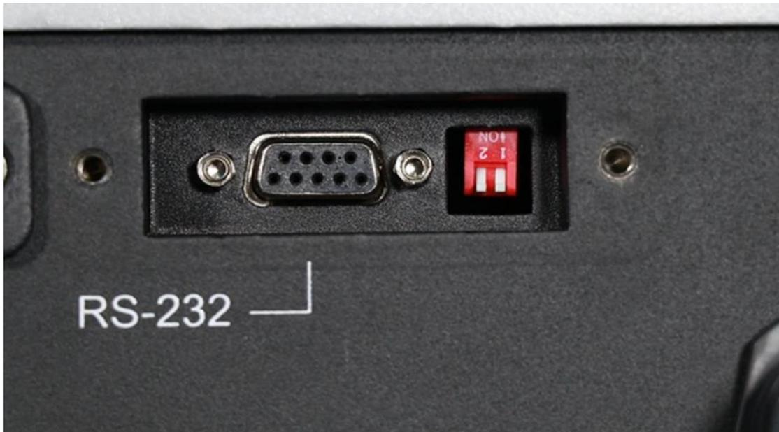
连接 RS232 转 RS485 转换器时，把 2 针拨码开关的 1 号针脚向下拨到 OFF，如下图：
