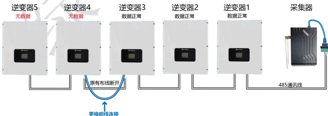
如果按照上面的方法连接后数据还是没有上来，那么将后端连接的逆变器进行断开（5 断开），看 4 号是否通讯上（如下图），如果通讯正常，则数据通讯异常的问题可能是 5 号设备引起的。当 4 号设备通讯正常后，再将 4 和 5 之间的通讯线连接起来，看 4 号设备是否受到影响，如果连接后 4 号设备再次异常，则确定是 5 号设备问题。
