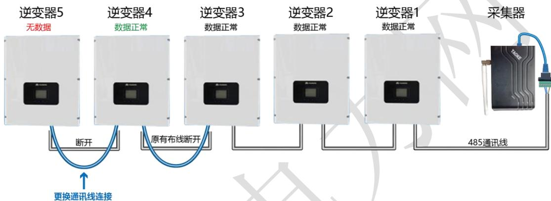
情况二：若是总线中间设备无数据，这几台逆变器自身通讯端口接线存在问题可能性较大，可以将接口重新接一下；
