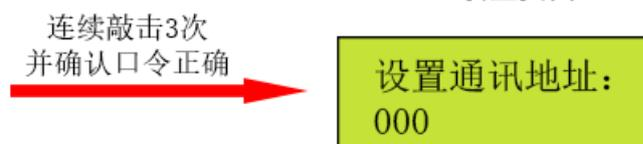
在对应的参数设置页面敲击2次则进入设置状态，输入设置方法和输入口令的方法一致。
