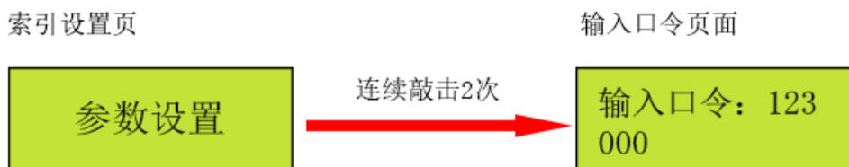
3. 输入口令：敲击面板2次使能输入口令，第一个数字开始闪烁，然后再敲击一次改变数值大小，使第一个数为“1”；然后连续敲击两次使第二个数字开始闪烁，这时敲击一次改变数值大小，使第二个数为“2”，相同方法使第三个数字为“3”，当 LCD 页面显示如下时，连续敲击三次，确认设置结果。
