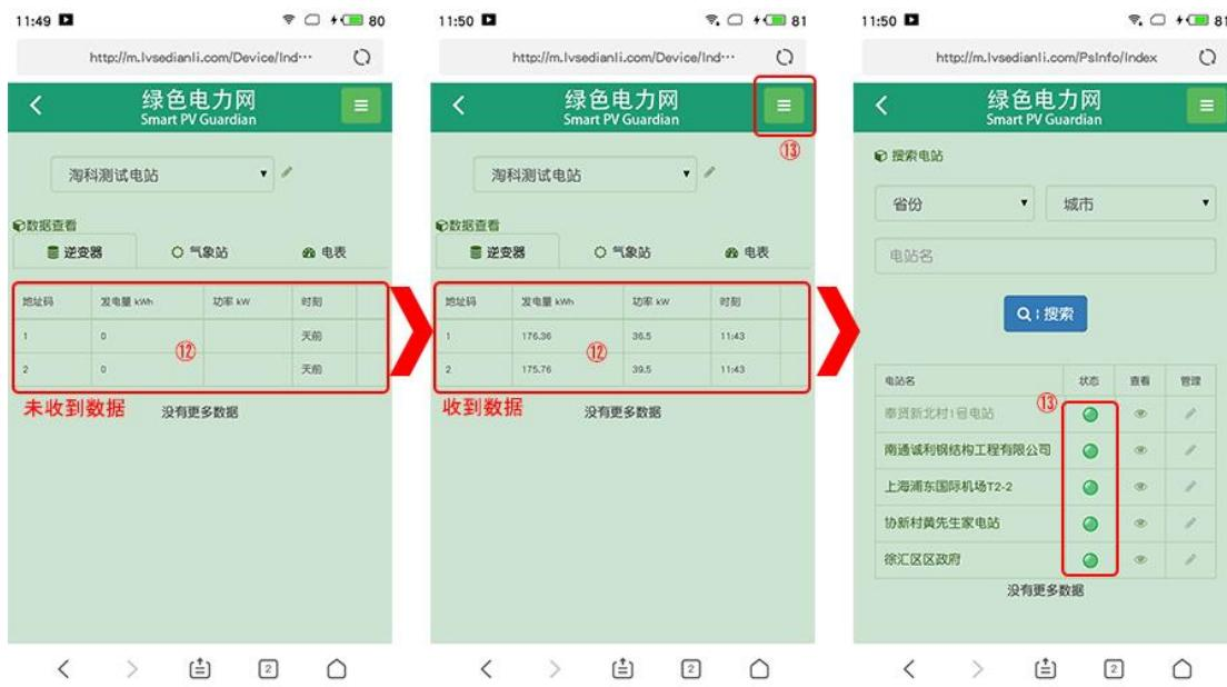
⑫设备同步后，等待约 5~15 分钟即可接收到第一条数据（根据具体项目情况和采集间隔，等待的时间可能不尽相同，一般需要 15-30 分钟），接收到数据后，用户可以跟现场设备上显示的数据核对，核对无误后则证明数据解析正常，如果核对显示数据与现场实际数据有较大出入，请及时联系 TAOKE 售后技术支持人员。
