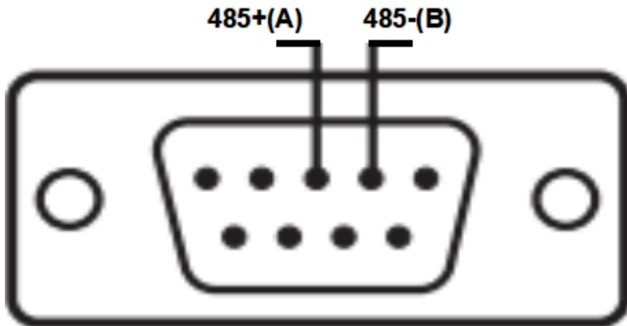
2. 使用剥线钳剥去通讯线缆的绝缘层,通讯线缆建议采用 2 芯屏蔽线, 接头处采用端子压线方式, 接入逆变器的 A, B 接口, 如下图所示:
