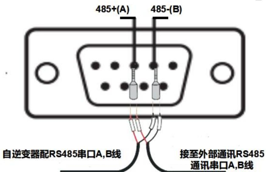
3. 重复上述方式连接所有逆变器, 连接完成后通讯线屏蔽层单点接地以提高可靠性, 如下图所示:
