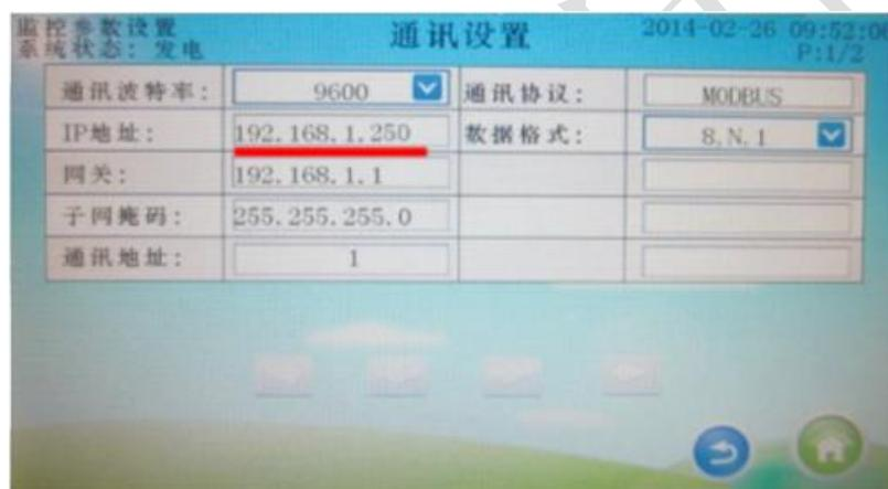
同样的方式，点击网关设置框及子网掩码设置框，分别完成网关设置及子网掩码的设置。如下图所示：
