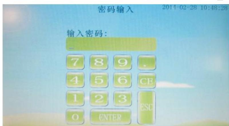
4. 在密码输入界面输入默认密码“123456”，即可进入参数设置主界面，如下图所示：
