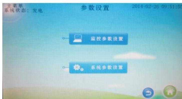
5. 出现上述参数设置界面后，点击“监控参数设置”进入设置界面，监控参数设置第一页即为“通讯设置”页面，如下图所示：
