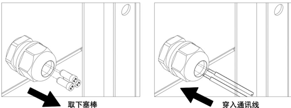
第三步：将通讯线接入逆变器的 RS485 通讯口 P7⑤，多台设备组网通讯时，每个接口接入两组通讯线，如下图：
