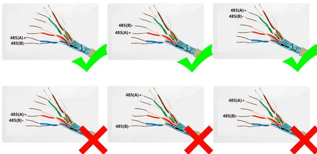
485 通讯屏蔽线缆：采用 485 通讯专用的双绞屏蔽线缆，直径 $\geq 1.0\text{mm}$ ，如下图：
