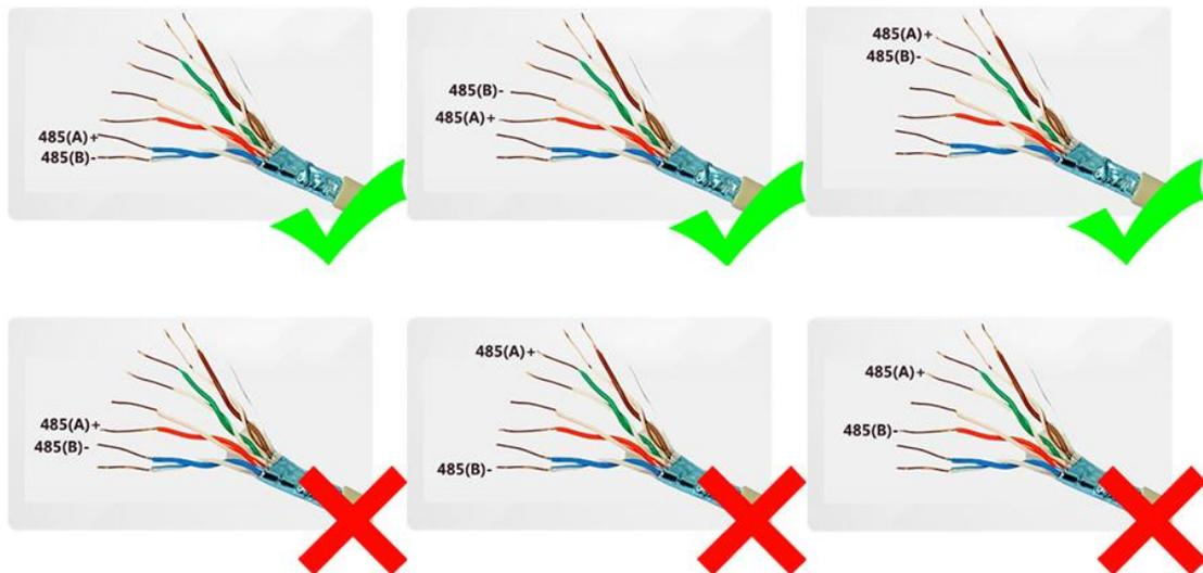
485 通讯屏蔽线缆: 采用 485 通讯专用的双绞屏蔽线缆, 直径 $\geq 1.0\text{mm}$ , 如下图:
