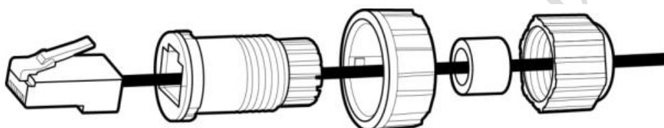
通信线连接示意图（水晶头）
