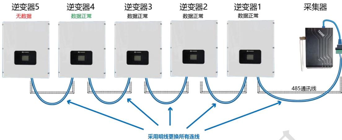
如果明线连接过后仍然数据不稳定,请尝试更换采集器,查看是否数据稳定;如果现场怀疑是某一台逆变器影响到线上的其他逆变器通讯稳定性,可以采用逆变器交叉断电法,将问题设备的交流和直流电同时断开,看其他设备的数据是否正常,如果正常,则确认是被怀疑设备的问题,如果仍然不正常,则是其他原因引起的,请咨询相关专业人员或联系 TAOKE 售后技术支持人员。
