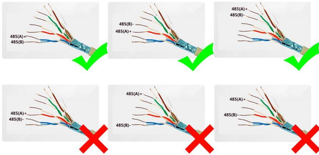
485 通讯屏蔽线缆：采用 485 通讯专用的双绞屏蔽线缆，直径 $\geqslant 1.0\text{mm}$ ，如下图：
