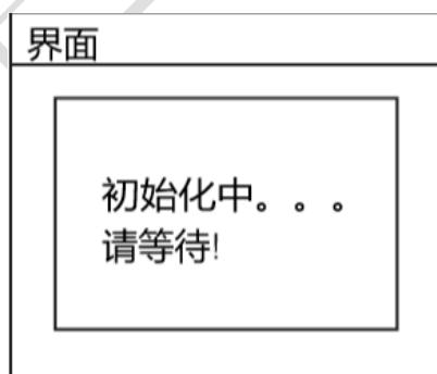
2.当初始化结束后，显示屏进入一个主循环菜单，循环显示逆变器信息。按下 **ESC** 键退出
