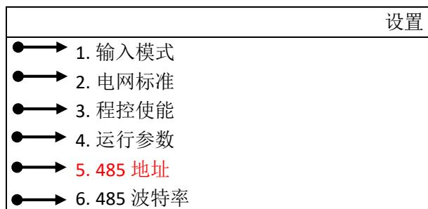
6.进入“485 地址”界面后，输入地址码，地址码输入值在 1—32 之间（同一台采集器下不能输入相同的地址码），按 UP/DOWN 键增加或者减少输入的数字，地址码输入完成后按 ENTER 键确认并自动返回到设置界面。
