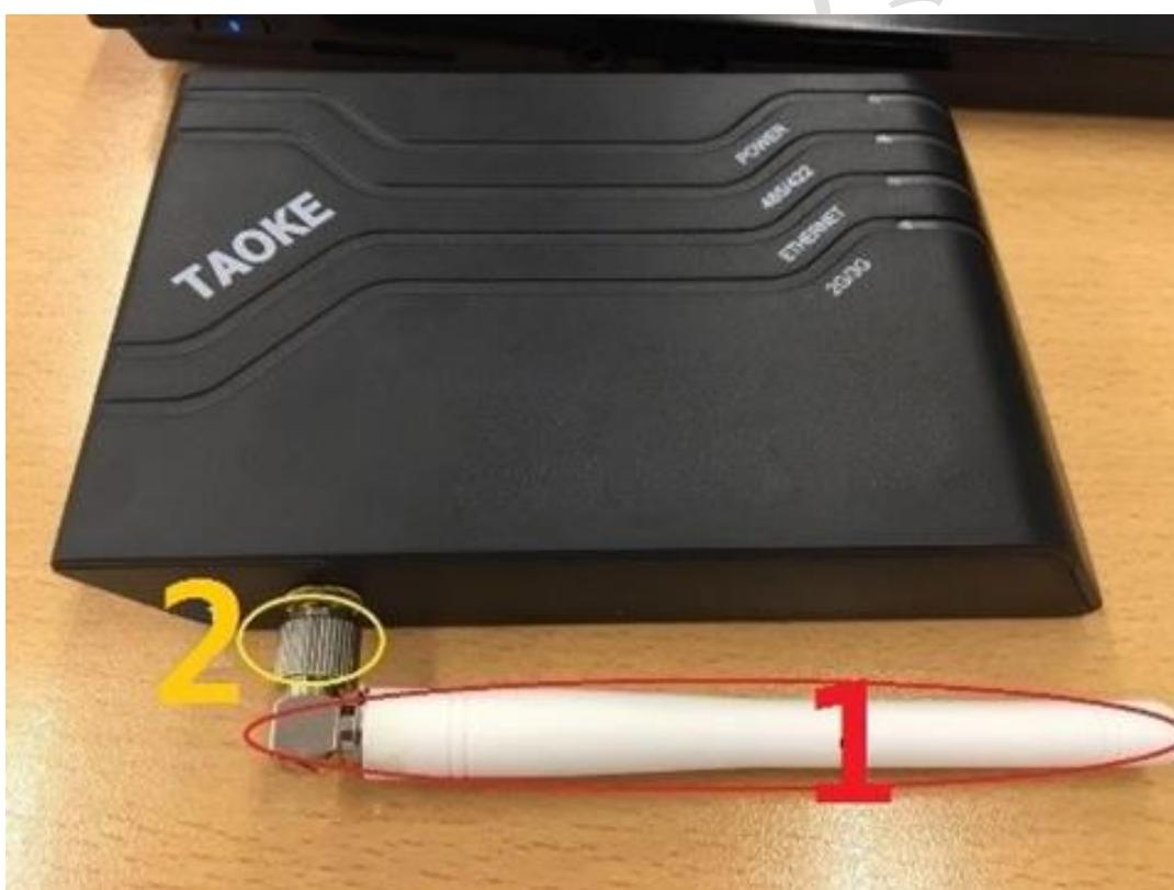
注意五：采集器的天线不能碰到任何金属或电线等异物；如未购买塑料防水盒，安装在金属配电箱内，则需要安装一个 2 米或 5 米的延长天线，天线应放置在配电箱或防水盒外部进行固定，如下图：
