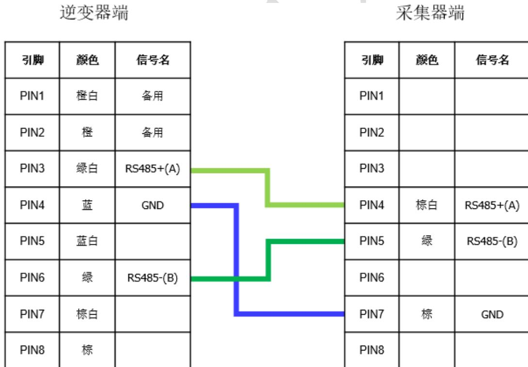
(备注：在实际应用中，兆能的单相逆变器有接 pin1 和 pin2 数据不通的案例，所以如果是单相逆变器，提倡接逆变器的 pin3 和 pin6)
