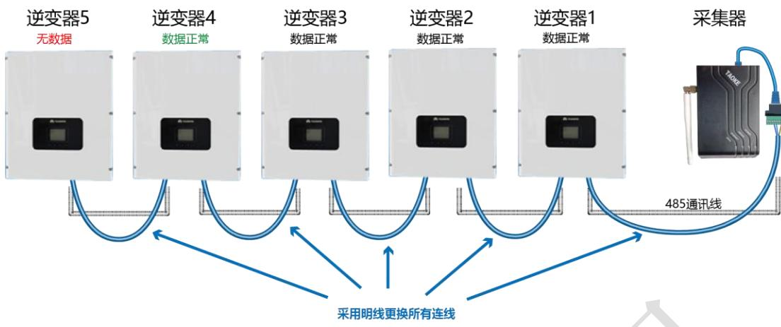
如果明线连接过后仍然数据不稳定，请尝试更换采集器，查看是否数据稳定；如果现场怀疑是某一台逆变器影响到线上的其他逆变器通讯稳定性，可以采用逆变器交叉断电法，将问题设备的交流和直流电同时断开，看其他设备的数据是否正常，如果正常，则确认是被怀疑设备的问题，如果仍然不正常，则是其他原因引起的，请咨询相关专业人员或联系 TAOKE 售后技术支持人员。
