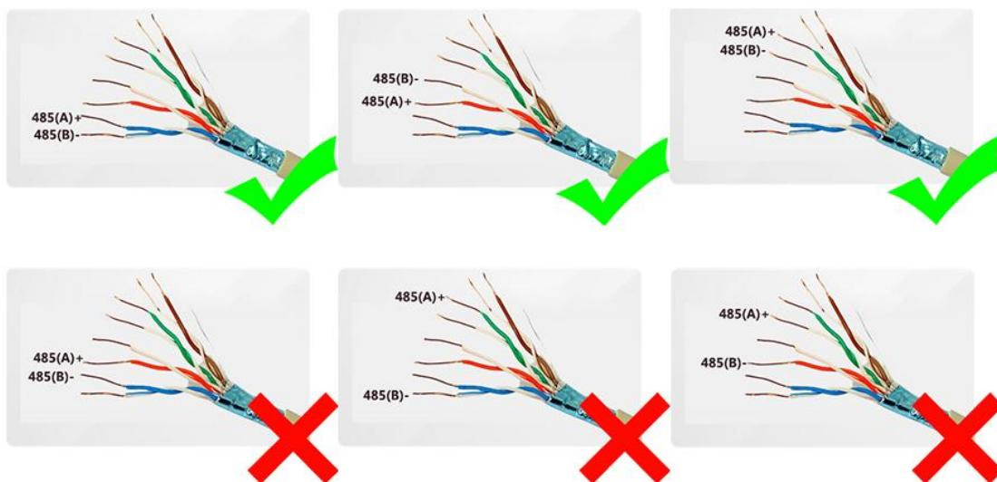
485 通讯屏蔽线缆：采用 485 通讯专用的双绞屏蔽线缆，直径 $\geqslant 1.0\text{mm}$ ，如下图：
