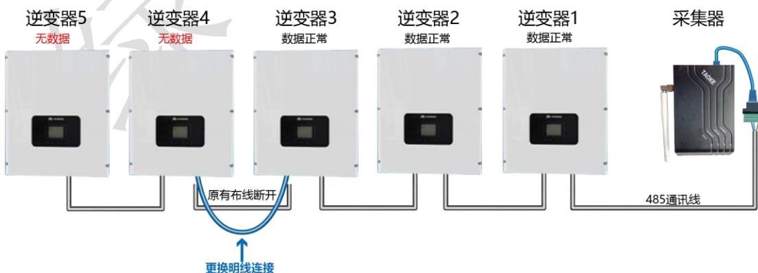
如果按照上面的方法连接后数据还是没有上来，那么将后端连接的逆变器进行断开（5 断开），看 4 号是否通讯上（如下图），如果通讯正常，则数据通讯异常的问题可能是 5 号设备引起的。当 4 号设备通讯正常后，再将 4 和 5 之间的通讯线连接起来，看 4 号设备是否受到影响，如果连接后 4 号设备再次异常，则确定是 5 号设备问题。
