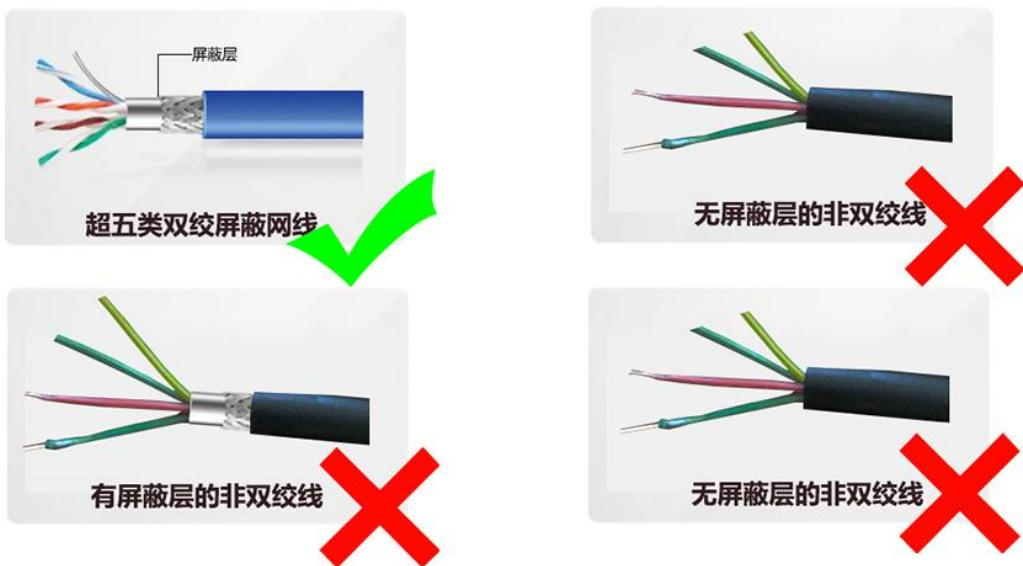
在超五类屏蔽网线里，与设备 485 通讯口 A 和 B 相连接的必须是同一股双绞线中的两根线，具体接线标准如下图：
