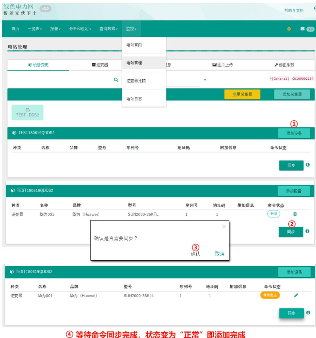
同步完成后，就可以正常采集设备数据了，请在 Smart-PV 网站的“设备历史”菜单查看实时采集数据，数据正常后就可以利用 Smart-PV 数据平台进行电站管理了；监控平台详细功能说明，请参考平台右上角的“帮助与文档”。
