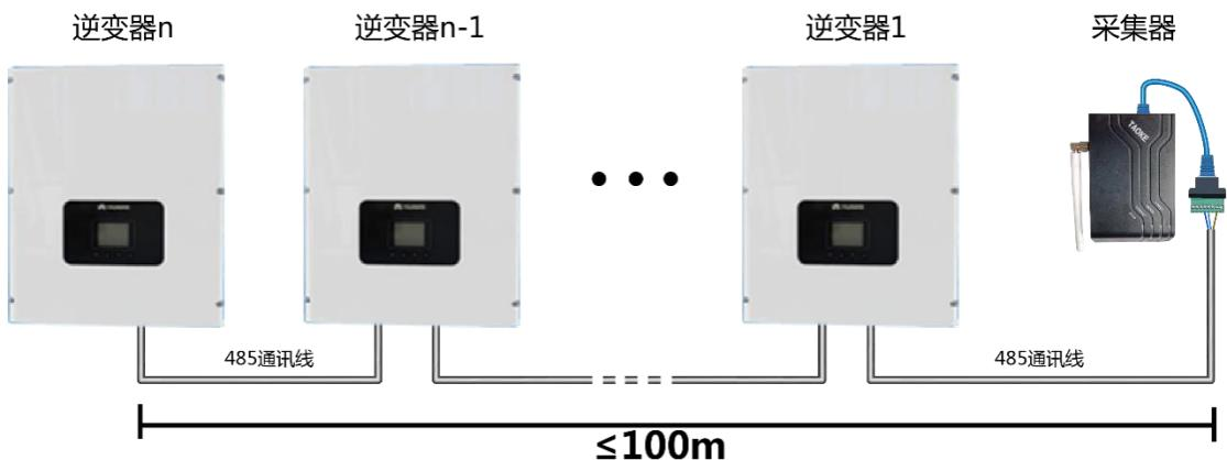
注意八：为了尽可能的减少通讯干扰，高压电站的通讯布线时，要么采用金属套管，要么通讯线与光伏交直流线缆保持 1 米以上的距离。
